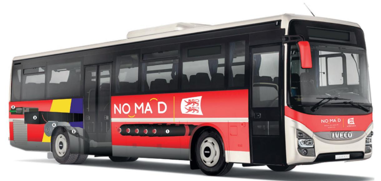
1. Réservoir d'hydrogène / 2. Pile à combustible / 3. Batteries d'accumulateurs / 4. Moteur électrique / 5. Transmission
