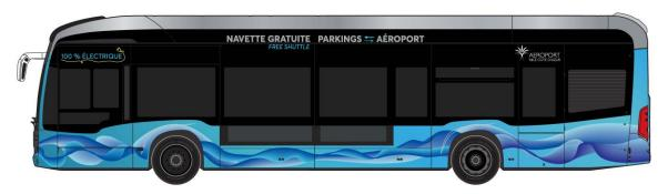
Dotés d'une autonomie de 160 km (ou de 8 heures), cette flotte permettra la circulation en simultanée et en continu de 2 navettes bénéficiant en outre d'un procédé de rechargement en continu par récupération de l'énergie cinétique.
